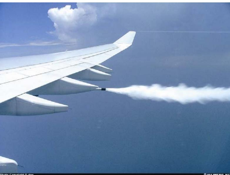
Nur Langstreckenflugzeuge sind mit Vorrichtungen zum Treibstoffnotablass ausgerüstet. (Foto: DNA)
