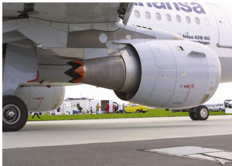
Bei Testflügen der Lufthansa brachte die gezahnte Chevron-Düse eine Lärminderung von einem Dezibel. (Foto: Deutsche Lufthansa)
